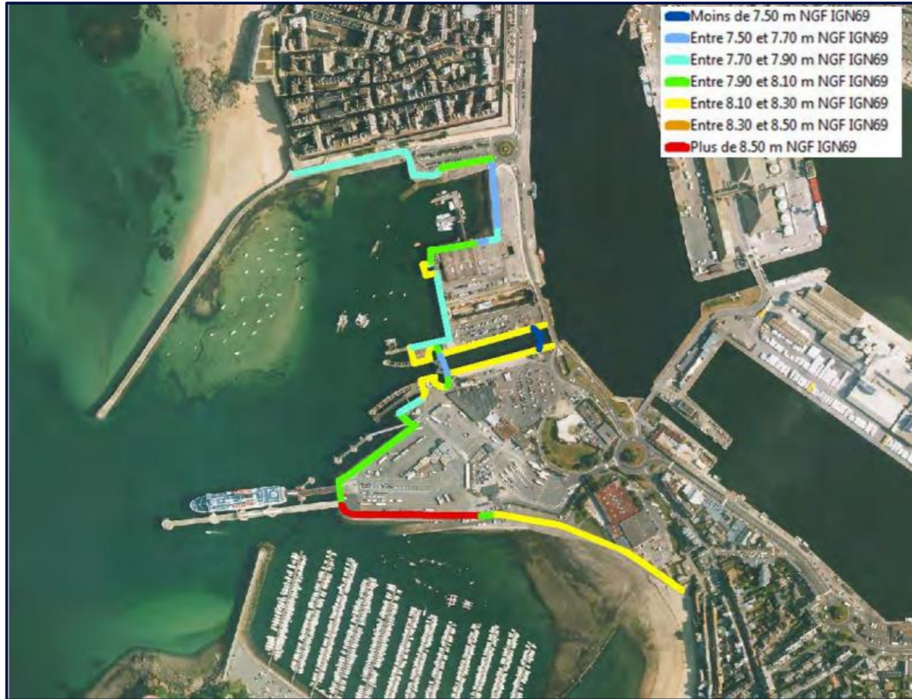
Figure 220 : Altimétrie des différents ouvrages sur le terminal (Source : PPRSM de Saint-Malo, DHI, 2017)
