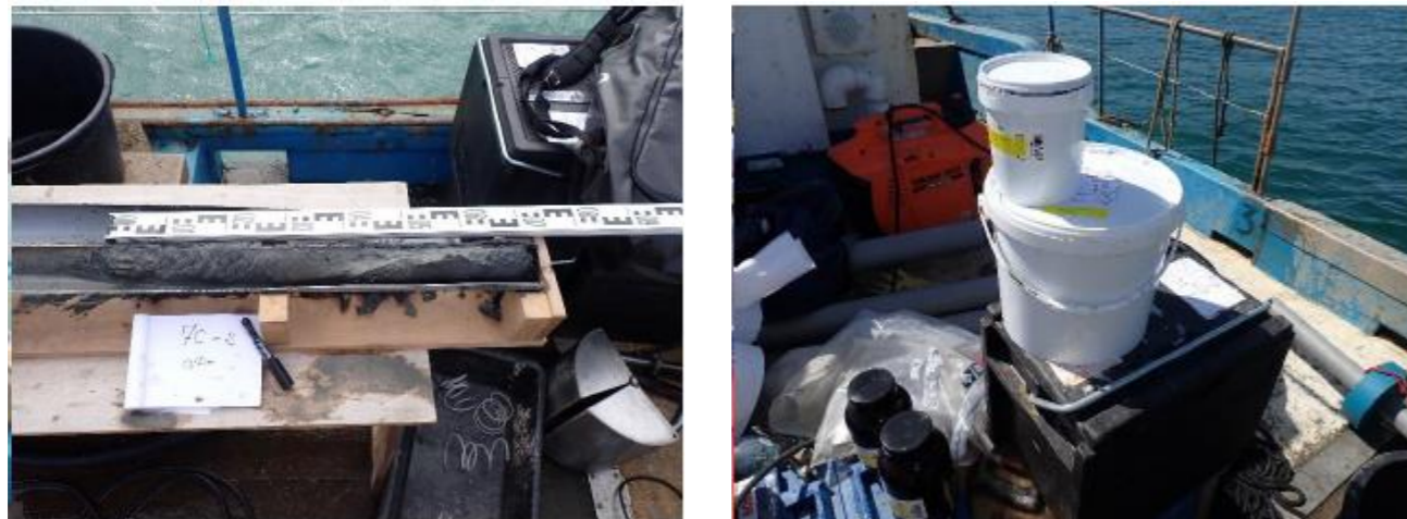
Figure 49 : Ouverture des carottes et conditionnement des échantillons (Source : CREOCEAN)
